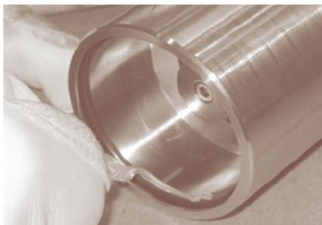
图 22：在 O 型圈上使用润滑油
