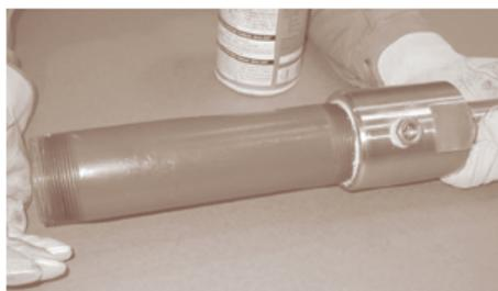
图 5：安装阀门适配器
