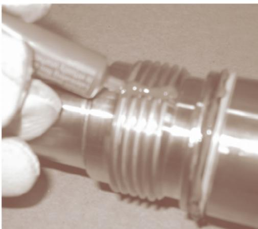
图 8: 润滑压力塞和 O 型圈
