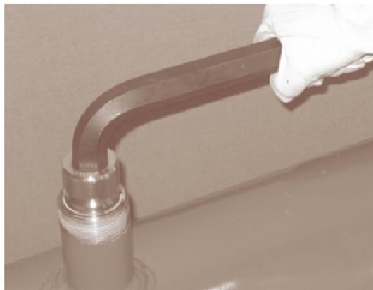
图 36: 紧固压力塞
