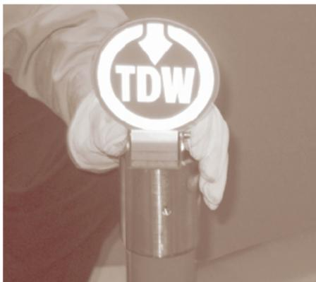
图 23: 安装旗语信号指示器
