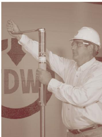
图 18: 置入压力塞
