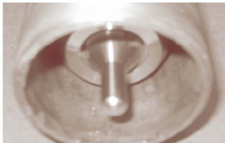
图 9: 缩回压力塞组件
