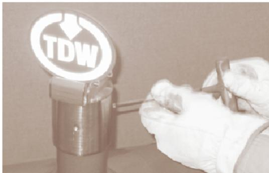
图 39: 安装锁定螺丝
