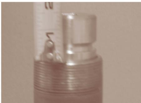
图 20：压力塞被置入
