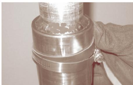
图 26: 固定加长杆的柱基
