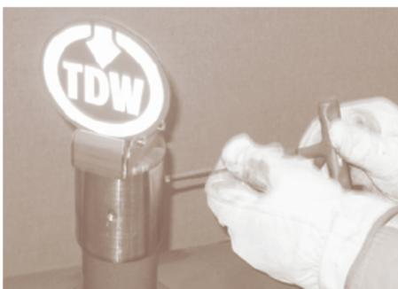
图 24: 安装锁定螺丝
